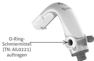
Abbildung 11. Zu schmierender Haltering
